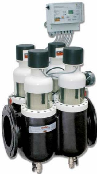
Αυτοκαθαριζόμενο φίλτρο νερού, φλαντζωτό, θερμοκρασίας λειτουργίας έως 30 °C με μηχανισμό αναστροφής της ροής και πιστοποίηση για πόσιμο νερό βάσει των Γερμανικών κανονισμών DVGW - TUV - DIN 19632.
