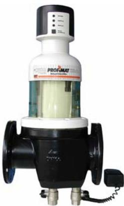
Αυτοκαθαριζόμενο φίλτρο νερού, φλαντζωτό, θερμοκρασίας λειτουργίας έως 30 °C με μηχανισμό αναστροφής της ροής και πιστοποίηση για πόσιμο νερό βάσει των Γερμανικών κανονισμών DVGW - TUV - DIN 19632.
